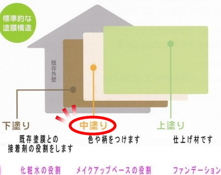
通常の塗装工事の場合、3層塗りで仕上げます。このうちの2回目の塗装が中塗りです。下塗りでは接着剤を塗りましたが、この中塗りからはお客様がお選び頂いた色の塗料（シリコン・ラジカル・フッ素etc…）を塗装していきます。
