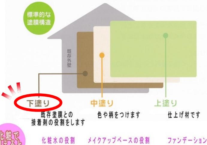
塗装は「下地が命」です！通常の塗装工事の場合、3層塗りで仕上げます。このうちの1回目の塗装が接着剤の役割である下塗りです。下塗りをする際に使用する量を「規定缶数量」といいます。
