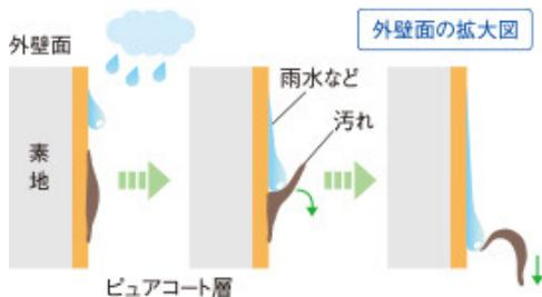
ピュアコートは水が表面に馴染む状態の「超親水性」にします。超親水性の表面では、水は膜のように広がるため、雨水などが壁の汚れの下に入り込み、浮き上がらせて流します。太陽光が当たりづらい北面なども汚れをつきにくくします。
