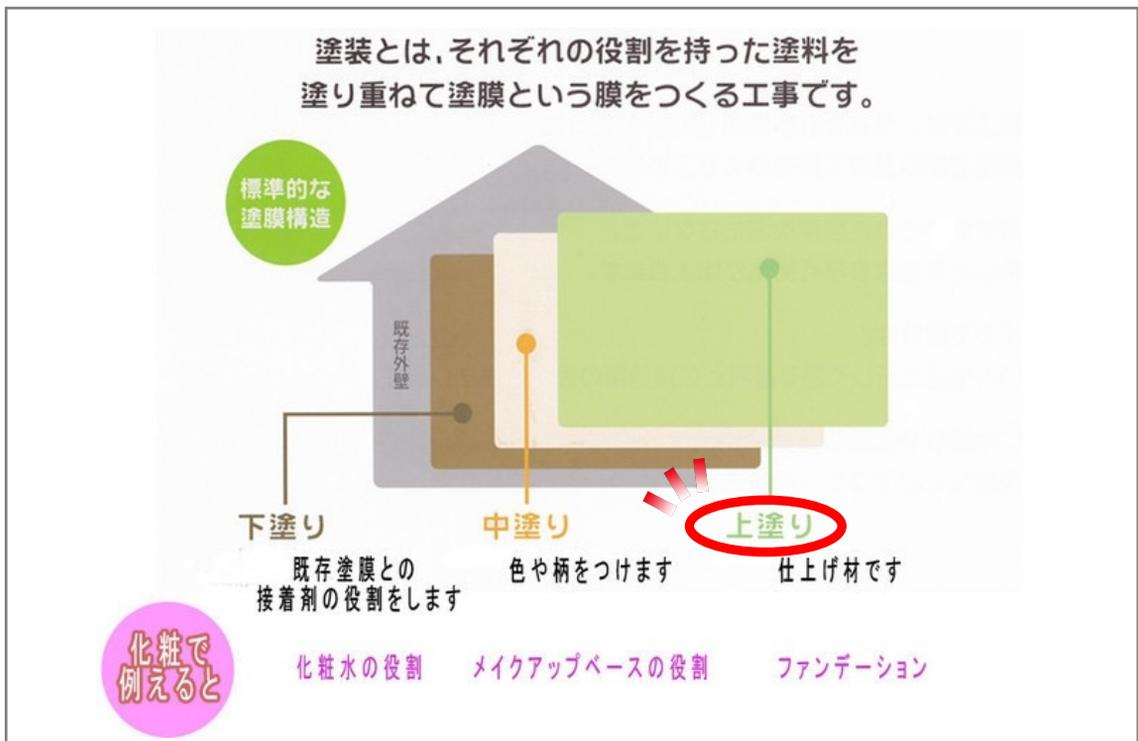
通常の塗装工事の場合、3層塗りで仕上げます。このうちの3回目の塗装が上塗りです。基本的には、中塗りで使用した色の塗料と同じものを塗装します。もしご希望があれば中塗りと上塗りの色を変える事によりしっかり3層塗りしているかを分かりやすくする事もできます。しかし、ご希望の色をしっかりと出す為にもマニュアル通りの施工をオススメします。
